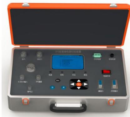
在封闭容器中，一定温度下的 SF6 气体压力可代表 SF6 气体的密度。习惯上把 20℃ 时 SF6 气体压力作为标准值。在现场校验时，在不同的环境温度下，测量的压力值都要换算成其对应 20℃ 时的压力值，用以判断 SF6 密度继电器的性能。
